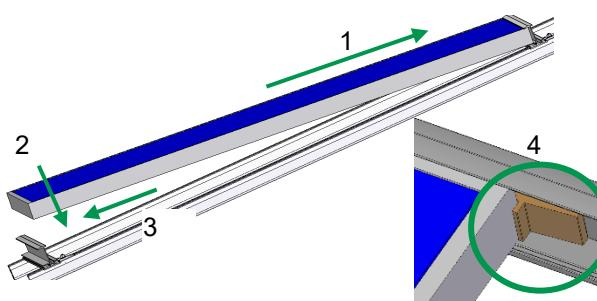
Nasadte modul na horní úložný profil a posuňte směrem nahoru (1). Poté modul usadte na dolní úložný profil (2) a posuňte dolů k profilu (3). Další moduly montujte stejným postupem, mezi moduly musí zůstat mezera min. 3 mm.
