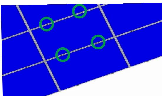
Poté se moduly připevní k profilům pomocí koncových a středových svorek.
