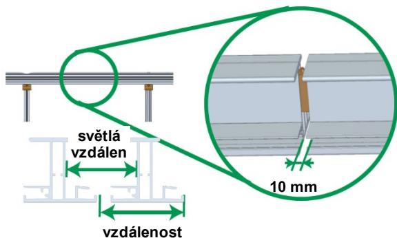
Úložný profil Plus připevněte k C profilu pomocí sady křížové profilové spojky C ÚP M8 stejným postupem jako úložný profil. Spojku zasuňte do úložného profilu Plus až na doraz a na spojku nasuňte druhý profil, přitom zachovávejte vzdálenost 10 mm.
