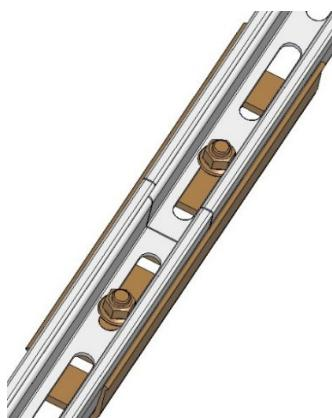
Srazte konce profilů k sobě. Spojku umístěte tak, aby se spoj nacházel uprostřed, a připevněte k profilům pomocí šroubů, které jsou součástí sady. Použitá spojka a počet šroubů se řídí typem profilu (VM 3).
