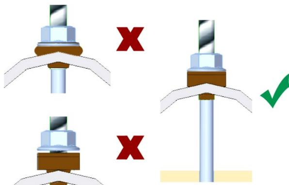
Utáhněte spodní samojistnou matici, až se těsnění z EPDM mírně stlačí – kužel těsnění se zanoří do předvrstaného otvoru ve střešní krytině.
