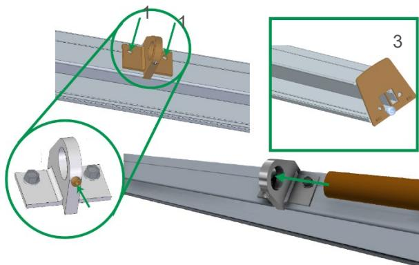
Držáky se k úložnému profilu Plus připevňují dvěma samořeznými šrouby (1). Kulatou trubku umístěte doprostřed a zafixujte šroubem (červíkem) (2).
