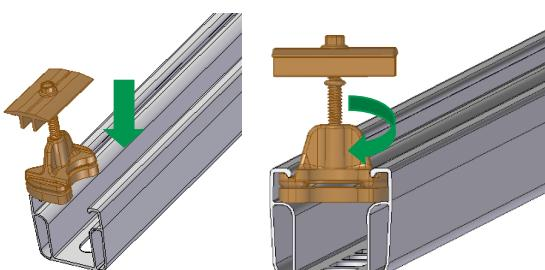
Středové, resp. koncové svorky zasuňte do komory profilu shora v místě upnutí. Poté v profilu otočte maticí a nasuňte modulové svorky na rám modulu.
