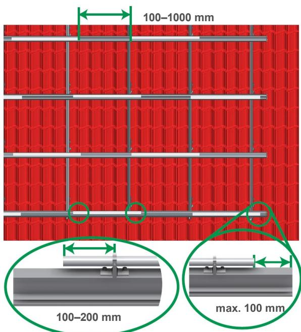
Vzdálenost konce kulaté Al trubky od konce úložného profilu v rohu zařízení max. 100 mm. Vzdálenost mezi trubkami min. 100 a max. 1000 mm.
