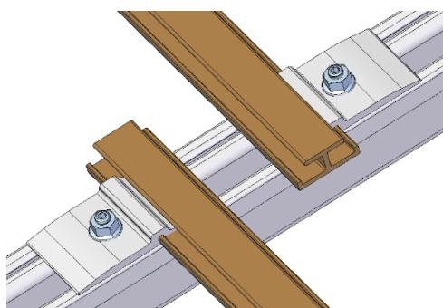
Podpěrnou lištu ÚP upevněte pomocí sady křížové profilové spojky C ÚP – podpěrné lišty se montují rovnoběžně s úložnými profily a v místě překrytí C profilu se umísťují střídavě.
