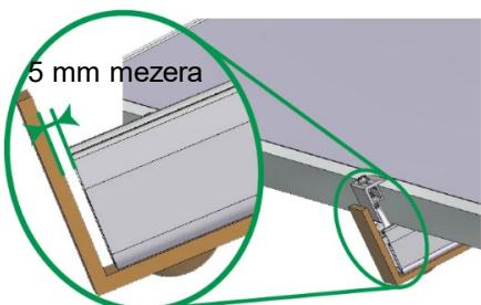
Před montáží modulu přišroubujte na konec profilu s asi 5mm mezerou upevňovacím šroubem se samojistnou maticí zajištění proti skluzu (VM 6.1/6.2).
