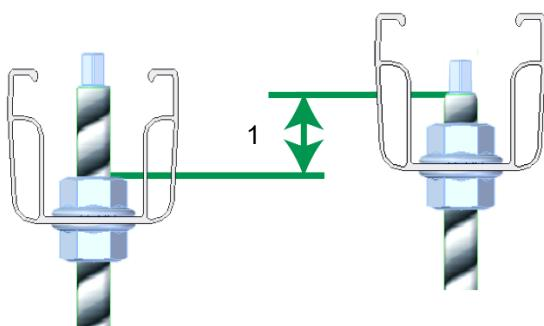
Umístěte C profil na spodní samojistnou matici, vyrovnejte výšku profilu odpovídajícím umístěním samojistné matice (1). Poté utáhněte horní samojistnou matici.
