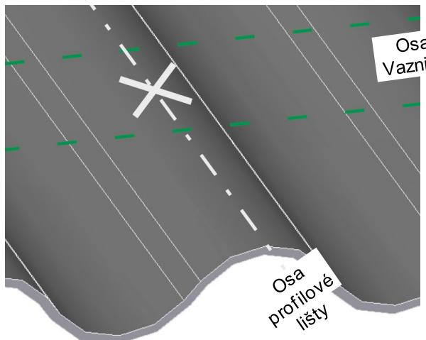
Vyznačte osu montážní profilové lišty na vrcholech vln / horních vlnách.
