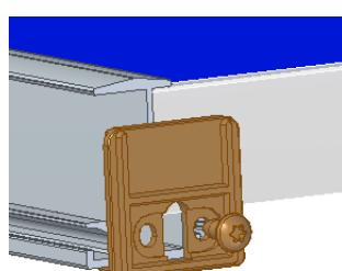
Na konec řady modulů připevněte ke kanálu pro šroub každého úložného profilu pomocí šroubu do plechu okrajovou zarážku.
