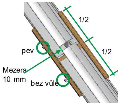
Nasuňte spojku na namontovaný profil tak, aby profil dosahoval do její poloviny, a pevně utáhněte první závitový kolík. Zasuňte do spojky druhý profil. Mezi profily musí zůstat mezera 10 mm. Druhý závitový kolík utáhněte bez vůle. Při montáži úložného profilu Plus postupujte podle VM 7.
