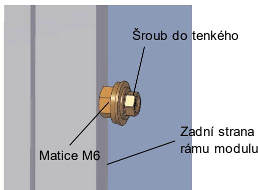
Před montáží modulu je třeba namontovat do otvorů v rámu přes spodní profil zajištění proti skluzu. Pro usnadnění montáže modulů se doporučuje použít protiskluzová zajištění u všech modulů.
