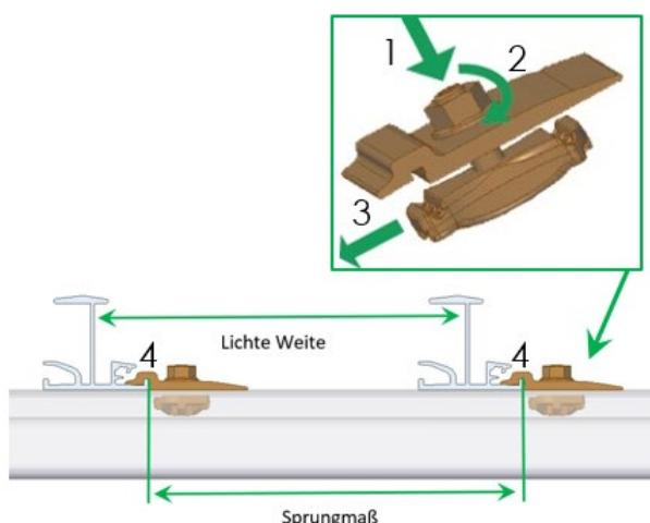
Vložte sadu křížové profilové spojky C ÚP M8 shora do drážky profilu (1). Otočte matici o  $90^\circ$  (2) a přisluňte komponentu k úložnému profilu (3) tak, aby se sada křížové profilové spojky C ÚP M8 zahákla do přídržné příruby (4).
