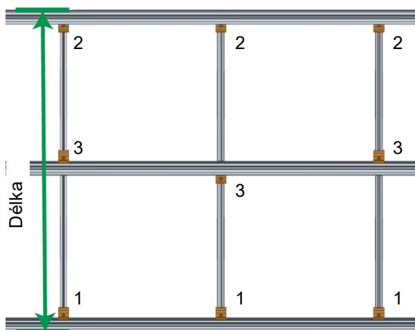
U nejhornějšího a nejspodnějšího úložného profilu modulového pole se sada křížové profilové spojky C ÚP M8 montuje vždy na vnitřní stranu (1, 2). U mezilehlých úložných profilů se spojky připevňují k přídržné přírubě střídavě nahoře a dole (3).
